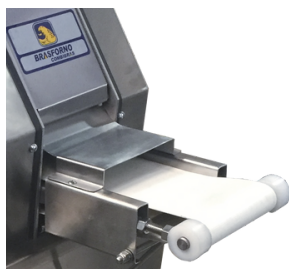
esteira de saída com proteção
